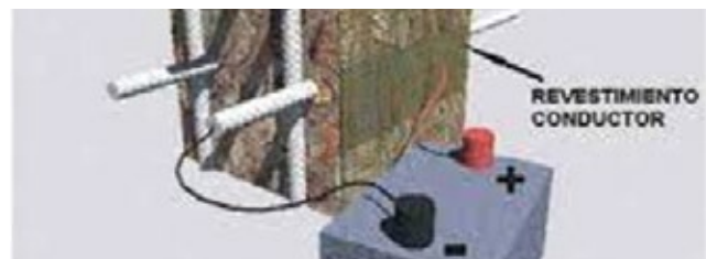
Figura 1. Esquema de armado de protección catódica por corriente impresa.
