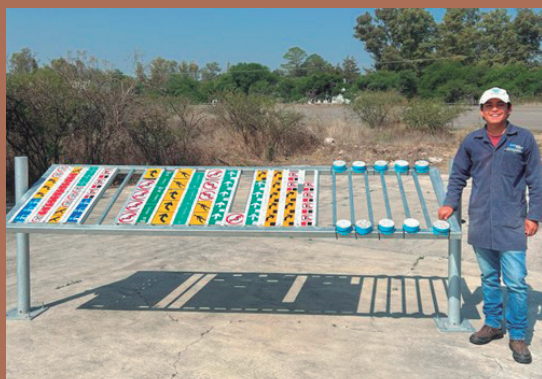
Figura 3. Núcleos de concreto recubiertos expuestos al ambiente.
