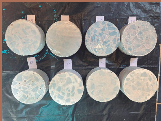
Figura 2. Ítems de concreto recubiertos con geopolímero.
