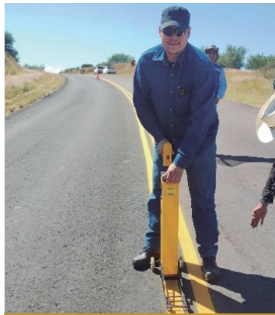
Figura 2. Medición de retroreflectividad de marcas en el pavimento.
