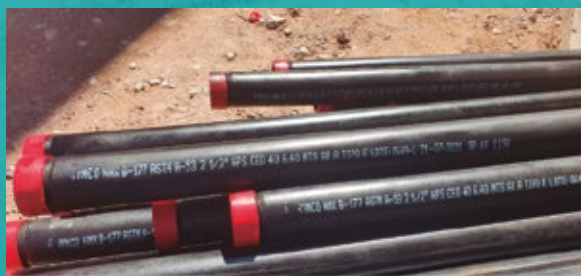
Figura 1. Armadura estructural cilíndrica del micropilote.
