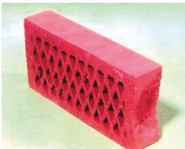
Figura 1. Desconchamiento originado por el vapor de agua acumulado en el interior del ladrillo en forma de bañera y con separación de partes enteras del ladrillo (Laboratorios Talleres Felipe Verdés S.A., Igualada, Barcelona, España).
