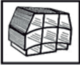
Figura 4. Disposición incorrecta de la bovedilla donde los arcos centrales contraerán más rápido que las bases. Estudios en Laboratorios Talleres Felipe Verdés S.A., Igualada, Barcelona, España.
