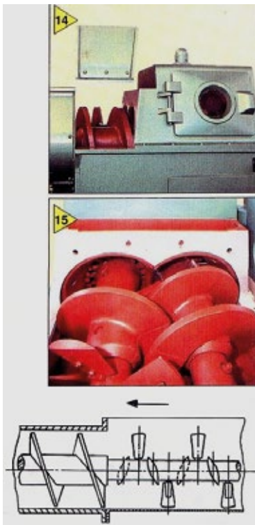
Figura 4. Esquema ilustrativo de sustitución de palas de masado por hélices (Talleres Felipe Verdés S.A., Literatura Técnica, Igualada, Barcelona, España).
