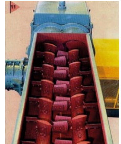
Figura 3. Amasadora de doble eje (Talleres Felipe Verdés S.A., Literatura Técnica, Igualada, Barcelona, España).
