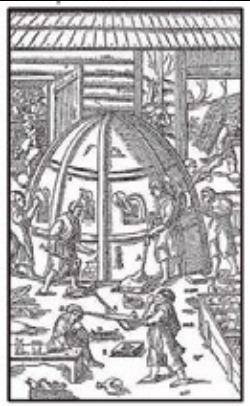
Figura 2. Fundiendo vidrio. Grabado de Re Metálica. 12 Libros sobre Minería y Metalurgia. Georgius Agricola (1494-1555, Basel 1557)
